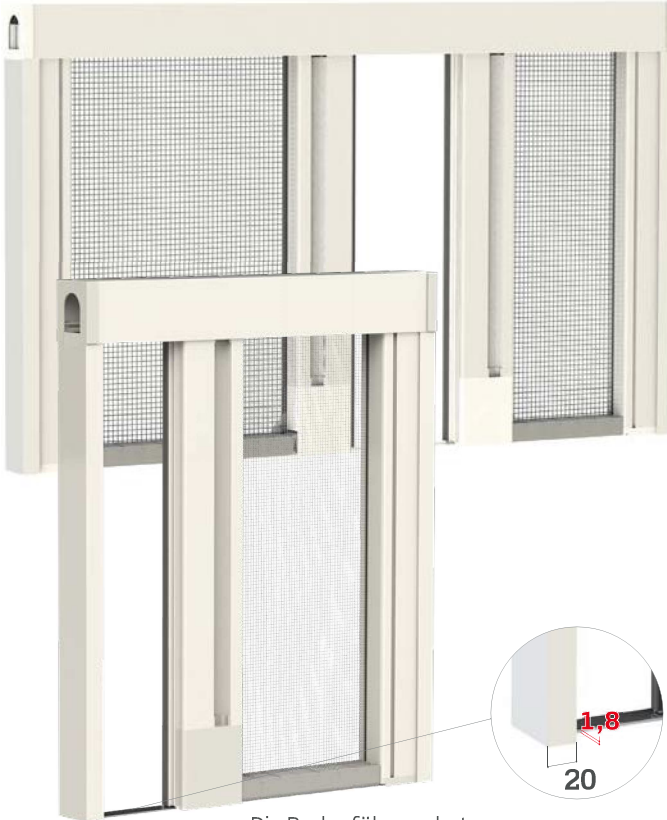
Die Bodenführung hat eine Dicke von 1,8 mm.
